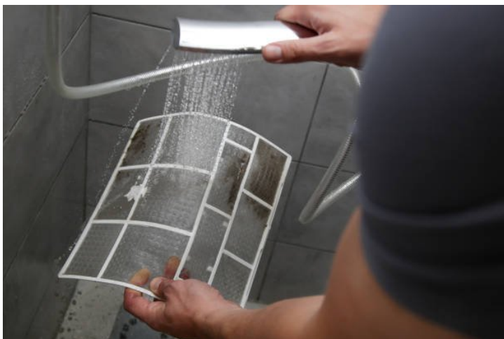
Hombre lavando un filtro de aire acondicionado muy sucio
